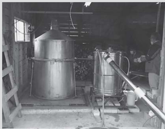
左の蒸留釜で薄荷を蒸し、その蒸気を右の容器で冷やすと、薄荷油と水が出てくる
