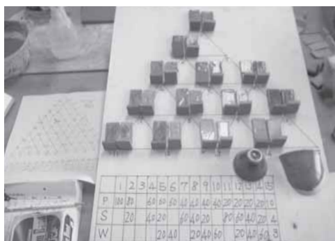
何種類も試作した釉薬（右写真）とテストピースの三角座標（左写真）。
