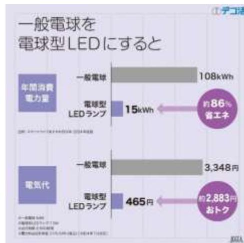
図 1-15 一般電球を電球型 LED にした場合の効果
